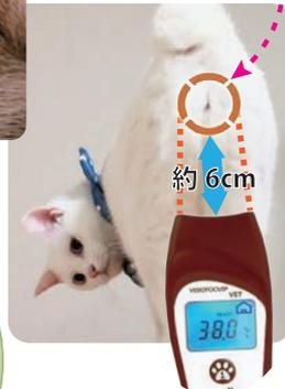
本製品の照準LEDライトは目に照射しても安全なライトです (EN 62471) レーザーではなくLEDであり、人間用の体温計にも使用されています。
