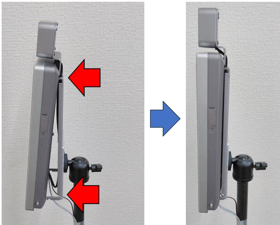
10.最後に両側の⑧の凸部の溝に事前に緩めていたネジを合わせ、④で締めましたら取付は完了です
