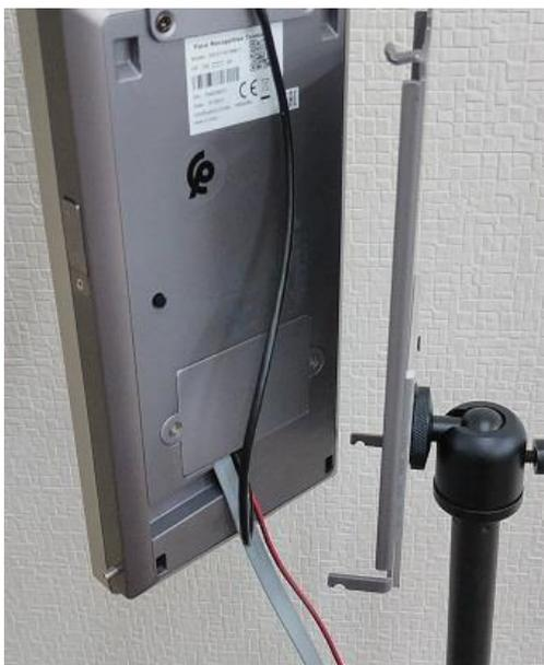
6.②と③を接続しましたら、左図の様に再び④を使って隙間からケーブルを出した状態で閉めます
