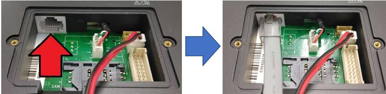
6.①に LAN ケーブルを挿しましたらケーブル類を挟まない様に注意してフタをして、ネジを⑨を使って閉めます
