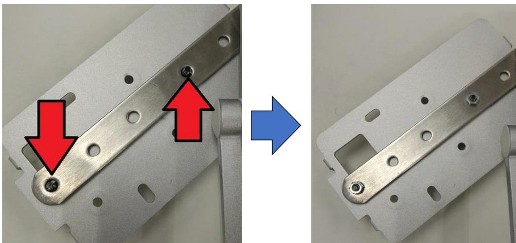
6.⑥に⑩を取り付けましたら、④が真っすぐになるように向きを調整して、下の右図の赤枠部分のネジを⑧で締めたら卓上スタンドと取付板の組立は完了です
