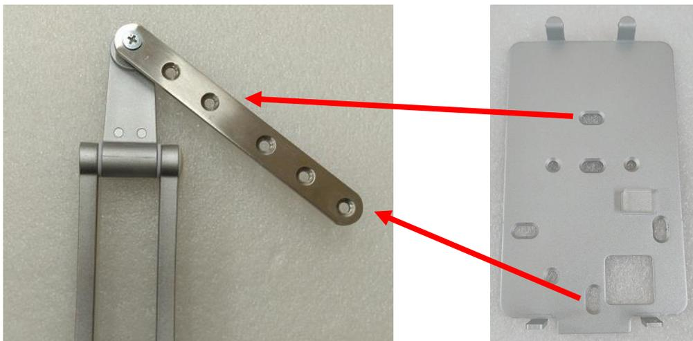
5.⑨が通りましたら、⑥の取付金具の裏面から出ているネジに⑩を付けて固定します
