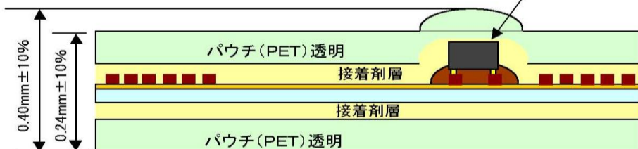
RFタグ断面図、層構成
