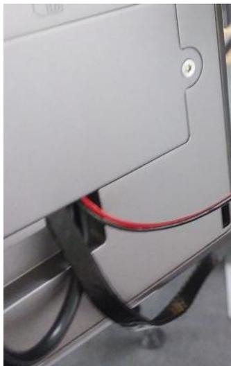
5.フタを閉め、ネジを付け、L型レンチで締めます
