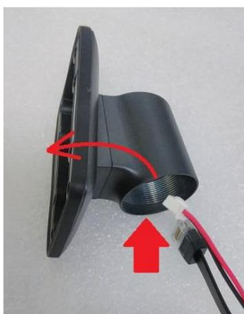
1.ポールの上部部分のテープを外し、2本のケーブルをヘッドの穴から、矢印の様にケーブルを通します
