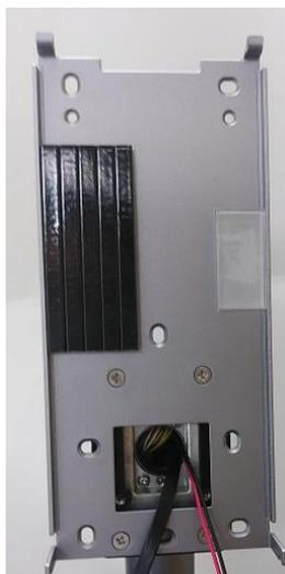
2.顔認識端末を取付板に取り付ける前に、端末本体下部にある固定用ネジを画像の様に L 型レンチで緩めます
