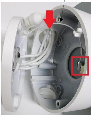
3.バレットの底から出ているケーブル類を手順2で外した穴から通します
