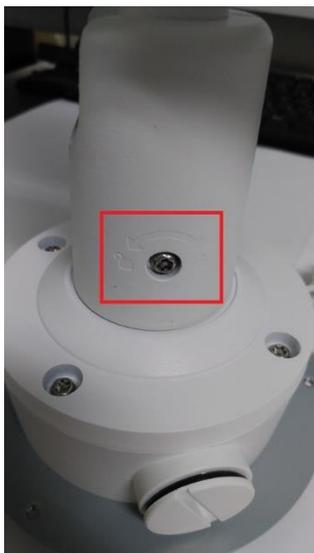
5.バレットのカメラの角度は初期の状態では真上を向いていますので、画像の赤枠の場所を付属のL型レンチで、半時計回りに緩めると、カメラの角度を調整出来るようになります
