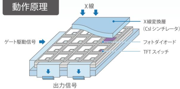
●CsI シンチレータによって、X線が光に変換されます
